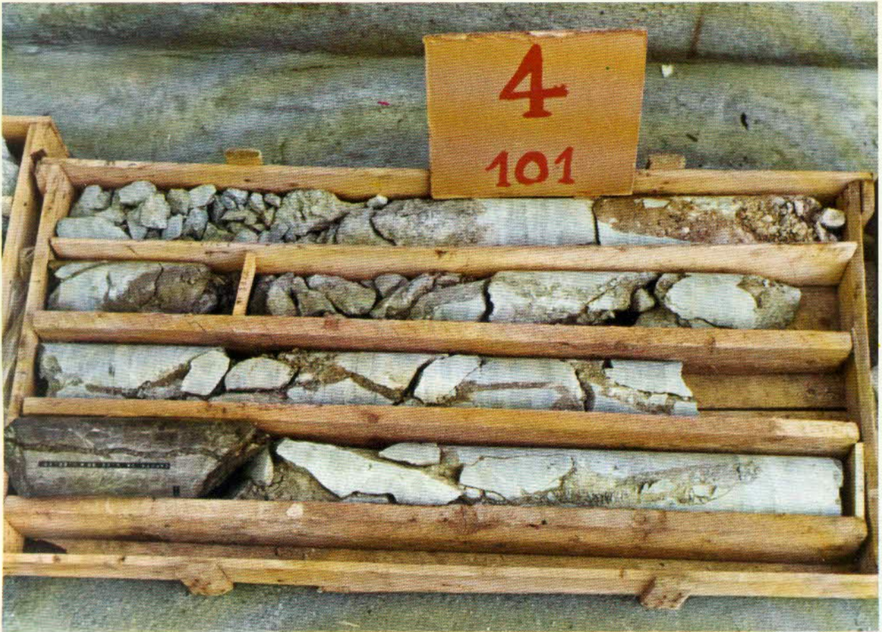
foto 6 - (sondaggio 101 cassa N. 4) Sondaggio a diamanti per l'esame dello stato della roccia.
